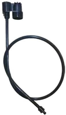
Espiga de 7 mm para conectar a la tubería secundaria y conexión presión soporte 8, 22 y 26 mm. Microtubo de 7 x 9 mm Ø y 90 cm de largo. Conexión tubo flexible y rosca hembra 1/2" NPT
