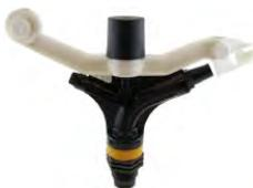
**SERIE 80-1.** Nueve boquillas disponibles con caudales entre 5.725 - 20.145 l/h a presiones entre 2,75 - 5,17 Kg/cm<sup>2</sup>. Radio de alcance de 20,4 a 29,8 m. Modelo normalizado con boquilla 32. Conexión rosca macho 1¼" BSP. Ángulo de 23°.
