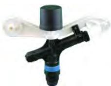
**SERIE 50-1.** Seis boquillas disponibles con caudales entre 1.475 - 3.975 l/h a presiones entre 2,10 - 4,50 Kg/cm<sup>2</sup>. Radio de alcance de 11,7 a 19,2 m. Modelo normalizado con boquilla 15 (marrón oscuro). Conexión con rosca macho ¾" NPT. Ángulo de 12° y 23°.
