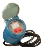
Lee y reacciona al diferencial de presión entre dos puntos de lectura. Proporciona señal al programador de riego. Requiere alimentación 6 - 24VCC o 12 - 24 VCA. Conexión rosca macho 1/8" BSP.
