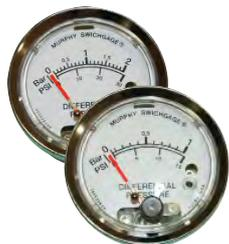
Manómetro diferencial de presión Murphy A20DPK y A25DPK con una lectura de presión diferencial de 0 a 10 m ó 0 a 20 m. La presión diferencial se ajusta entre estos dos valores. Cuando la presión diferencial alcanza el valor predeterminado (que se regula con extrema facilidad), se cierra el circuito que permite el paso de una señal eléctrica (máx. 30 VCA o VCC). Dial de 50mm Ø (A20) o 63 mm Ø (A25). Conexión con adaptador rosca hembra 1/8" BSP.
