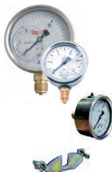
Manómetro de precisión en caja de acero inoxidable, relleno de glicerina antishock. Dial de 63 mm Ø con conexión de rosca macho 1/4" BSP en la base o de 100 mm Ø con conexión de rosca macho 1/2" BSP en la base.
