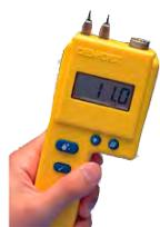
Utilizando la relación entre humedad y resistencia eléctrica el nuevo medidor **P-2000W/CS65** mide de forma eficaz el contenido de humedad en el papel. Rango de humedad en papel del 5% al 40%. Está especialmente indicado para pruebas en cartón, papel corrugado y tubos de papel. Almacena hasta 100 lecturas y muestra la media y la más alta de las lecturas almacenadas. Funciona con una pila alcalina de 9 V. Se suministra con su maletín.
