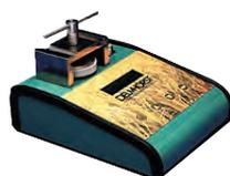
El medidor **G-7** se emplea para la medición de humedad en toda clase de granos y semillas. Rango de humedad del 9% al 30% según tipo de grano. Incorpora corrección automática por temperatura y memoria de hasta 150 lecturas. Funciona con una pila alcalina de 9 VCC. Se suministra con su maletín correspondiente.
