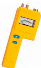
El medidor analógico **BD-10** está especialmente indicado para la medición de humedad en madera, hormigón, EIFS (Sistema de Aislación Exterior y Acabado Final), drywall y otros materiales. Rango de humedad del 6% al 40%. Funciona con una pila alcalina de 9 V. Se suministra con su maletín y agujas de contacto correspondientes.
