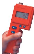
Utilizando la relación entre humedad y resistencia eléctrica el nuevo medidor **C-2000** mide de forma eficaz el contenido de humedad en las fibras de algodón. Es un instrumento indispensable para desmotadoras y a la hora de comercializar el algodón. Rango de humedad del 4% al 16% para fibra desmotada y 6% al 20% para fibra bruta. Funciona con una pila alcalina de 9 V. Se suministra con su maletín correspondiente.
