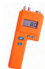
El medidor **J-2000/ART** está especialmente indicado para contratistas de suelo que trabajan principalmente con madera. Rango de humedad del 6% al 40%. Realiza medias de hasta 100 lecturas acumuladas. Sistema de corrección integrado para 48 especies diferentes. Compensación de temperatura incorporada en Fahrenheit y Celsius. Funciona con una pila alcalina de 9 V. Se suministra con su maletín y agujas de contacto correspondientes.
