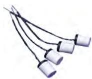
Sensor de bloque de yeso para la humedad del suelo formado por dos electrodos concéntricos empotrados en yeso para obtener una respuesta rápida de los cambios de humedad en el suelo. Se suministra con 200 cm (**GB-1**) ó 750 cm (**GB-2**) de cable según modelo.
