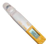
Medidor (Na+) Na-11 en estuche con dos pilas y estándar de repuesto 150 ppm y 2.000 ppm
