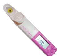
Medidor de potasio (K+) K-11 en estuche con dos pilas y estándar de repuesto 150 ppm y 2.000 ppm
