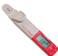
Medidor EC-11 en estuche con dos pilas y estándar de repuesto 1,41 mS/cm. Calibración 2 puntos.
