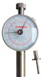
Penetrómetro analógico suministrado con cabezal de 3,5 mm con valor de escala de 2-15 kg/cm<sup>2</sup>, resolución ±2% y profundidad 10 mm
