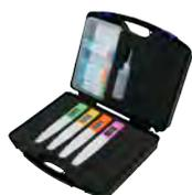
Maletín con 4 medidores (Calcio Ca-11, Nitratos NO<sub>3</sub><sup>-</sup>11, Potasio K-11 y Sodio Na-11) y 3 posiciones vacías con las pilas, soluciones e instrucciones correspondientes
