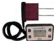
**FieldScout TDR150.** Medidor de humedad volumétrica y conductividad eléctrica del suelo y temperatura de la superficie. Dispone de datalogger con capacidad de 50.000 lecturas geoposicionadas. Pantalla LCD retroiluminada. Conectividad FieldScout Móvil/SpecConnect. La funcionalidad de Bluetooth y GPS es opcional y debe activarse por separado. El sensor infrarrojo de temperatura es opcional. Se suministra con funda de transporte. Deben solicitarse los conjuntos de dos varillas por separado.
