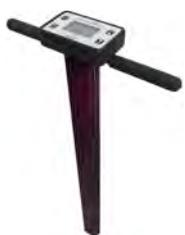
**FieldScout TDR250.** Medidor de humedad volumétrica del suelo. Dispone de datalogger con capacidad de 124.00 lecturas. Pantalla LCD retroiluminada. Mango en forma de T. Debe solicitarse los conjuntos de dos varillas por separado.
