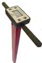
**FieldScout TDR350.** Medidor de humedad volumétrica y conductividad eléctrica del suelo y temperatura de la superficie. Pantalla LCD retroiluminada. WMango telescópico. Conectividad FieldScout Móvil/SpecConnect. Dispone de Bluetooth y GPS integrado y datalogger con capacidad de 50.000 lecturas con geo-posición. El sensor infrarrojo de temperatura es opcional. Se suministra con funda de transporte. Debe solicitarse los conjuntos de dos varillas por separado.
