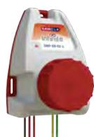
Equipo programador de 2 salidas Latch, con entrada para contador. Se alimenta con 2 pilas AA (incluidas). Entrada para contador universal (contacto libre de tensión). Apto para la arquitectura HUB (RF) y la arquitectura BLE (Bluetooth).
