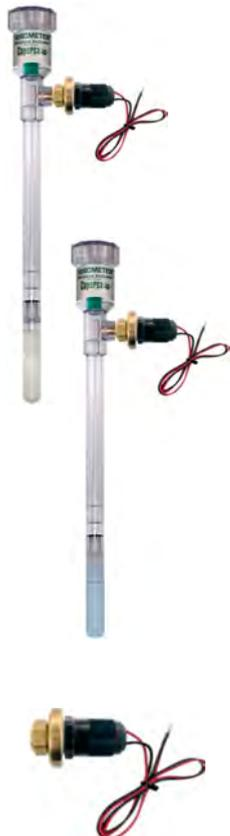
Además de la lectura visual, dispone de un relé eléctrico AVS-A. A un valor de humedad del suelo, predeterminado por el usuario entre 10 y 95 cb, permite el paso de una señal eléctrica a la válvula o controlador. Para trabajar con corriente alterna o continua hasta 24V. Normalmente abierta. Para su puesta a punto necesita del equipo de servicio ES-1002.
