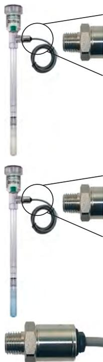
Recogen las lecturas de humedad en el suelo, para su transmisión por telemetría, cable o módem telefónico. Convierten una lectura de vacío en una señal de corriente de 4 a 20 mA directamente proporcional a la lectura en cb. El transductor está colocado en lugar del vacuómetro (opcional). Para la puesta a punto del tensiómetro, es necesario el equipo de servicio ES.
