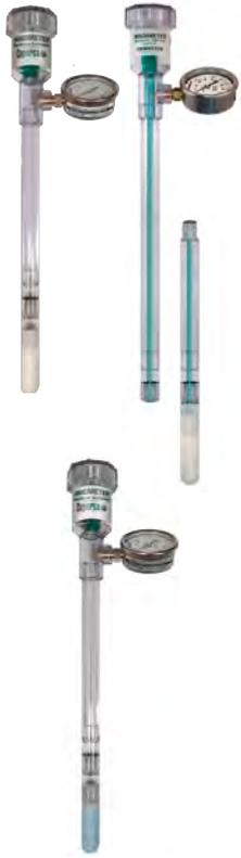
Tensiómetro de vacuómetro con punta cerámica roscada, fácilmente recambiable en caso de rotura. Para su puesta a punto necesita del equipo de servicio ES.
