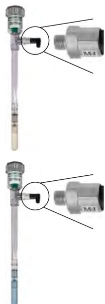
Recogen las lecturas de humedad en el suelo, para su transmisión por telemetría, cable o modem telefónico. Convierten una lectura de vacío en una señal de voltaje de 0 a 3 VCC o de 0 a 4,5 VCC directamente proporcional a la lectura en cb. El transmisor está colocado en lugar del vacuómetro (opcional). Para la puesta a punto del tensiómetro, es necesario el equipo de servicio ES.
