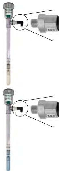
Recogen las lecturas de humedad en el suelo, para su transmisión por telemetría, cable o modem telefónico. Convierten una lectura de vacío en una señal de corriente de 4 a 20 mA directamente proporcional a la lectura en cb. El transmisor está colocado en lugar del vacuómetro (opcional). Para la puesta a punto del tensiómetro, es necesario el equipo de servicio ES.
