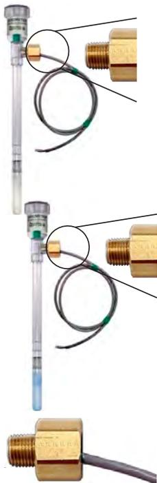
Recogen las lecturas de humedad en el suelo, para su transmisión por telemetría, cable o módem telefónico. Convierten una lectura de vacío en una señal de voltaje de 0 a 5 V directamente proporcional a la lectura en cb. El transductor está colocado en lugar del vacuómetro (opcional). Para la puesta a punto del tensiómetro, es necesario el equipo de servicio ES.
