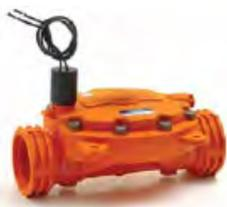
**Serie 2211:** Para funciones de apertura y cierre con solenoide 24VCA 2 vías. Para trabajar a presiones hasta 10 kg/cm<sup>2</sup>. Equipada con diafragma de 0,4 a 10 kg/cm<sup>2</sup>. Fabricada de nylon reforzado. Conexión rosca hembra BSP.
