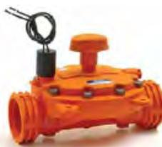
**Serie 2211T:** Para funciones de apertura y cierre con solenoide 24VCA 2 vías y regulación manual. Para trabajar a presiones hasta 10 kg/cm<sup>2</sup>. Equipada con diafragma de 0,4 a 10 kg/cm<sup>2</sup>. Fabricada de nylon reforzado. Conexión rosca hembra BSP.
