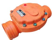
**Serie 2066:** Para funciones de apertura y cierre y regulación de presión, caudal, etc. Para trabajar a presiones hasta 10 kg/cm<sup>2</sup>. Equipada con diafragma de 0,4 a 10 kg/cm<sup>2</sup>. Fabricada de nylon reforzado. Conexión ranurada.
