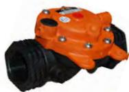
**Serie 2011:** Para funciones de apertura y cierre y regulación de presión, caudal, etc. Para trabajar a presiones hasta 10 kg/cm<sup>2</sup>. Equipada con diafragma de 0,4 a 10 kg/cm<sup>2</sup>. Fabricada de nylon reforzado. Conexión rosca hembra BSP.
