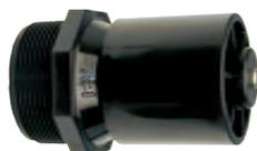
Permite el vaciado automático de las tuberías secundarias con lo que descarga al exterior cualquier acumulación de suciedad o precipitados. Imprescindible para las instalaciones de riego por goteo enterrado. Evacua un caudal de hasta 115 l/min hasta tanto no alcance una presión de 5 m (0,5 Kg/cm<sup>2</sup>) en cuyo momento se cierra.
