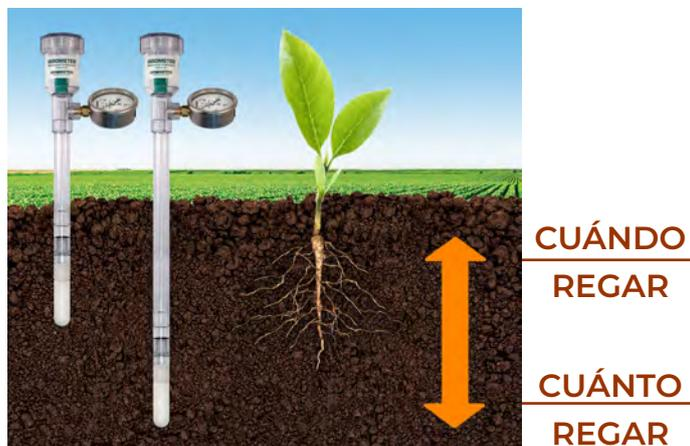
La gestión del riego en base a la monitorización de la humedad del suelo mediante tensiómetros Irrrometer se inicia con la elección de puntos de control en la finca, e instalando los equipos a las profundidades necesarias, según la disposición de las raíces del cultivo, con el objetivo de controlar la humedad en la zona radicular y adyacente.
