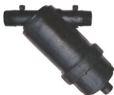
Filtro de plástico de malla o anillas para la separación de partículas finas de materia inorgánica (limos, arenas, etc.). Equipado con una malla (acero inoxidable modelos SS o plástico modelos PL) o anillas modelos DS de 120 micras (120 mesh) y una llave de purga manual. Presión máxima recomendada de trabajo: 8 kg/cm<sup>2</sup>. Se instala en posición horizontal o vertical.
