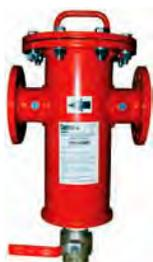
Filtro de malla de 3 mm de paso (3.000 micras - 5 mesh) para instalar en línea como filtro de desbaste para la separación de partículas gruesas (piedras, maderas, conchas, etc.) aguas arriba de un cabezal automático. Su uso es recomendable en las instalaciones que no dispongan de un equipo adecuado de prefiltros en la aspiración de bombas que aspiran de ríos o similares (ver serie 18100). Presión máxima recomendada de trabajo: 8 kg/cm<sup>2</sup>.
