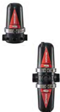
Filtro de anillas de plástico de alta calidad para la separación de partículas finas de materia inorgánica (limos, arenas, etc.). Equipado con anillas de 120 micras (120 mesh). Opcionales anillas de 80 micras (200 mesh) y de 100 micras (150 mesh). Presión máxima recomendada de trabajo: 8 kg/cm<sup>2</sup>. Se instala en posición horizontal o vertical.
