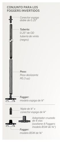
Los nebulizadores Fogger de Senninger reducen la temperatura de los invernaderos y aumentan los niveles de humedad. Generan las condiciones perfectas para la propagación de las plantas mediante la distribución de gotas extremadamente finas con un patrón de distribución altamente uniforme.
