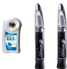
Refractómetro digital 0-53% Brix ATC
